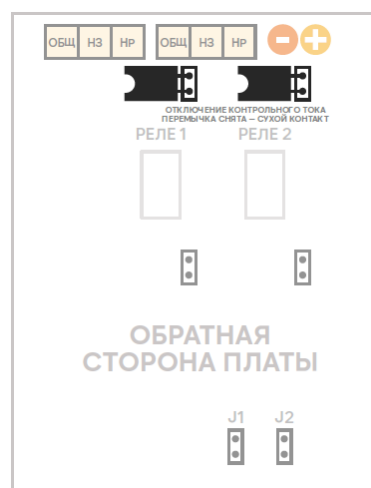
Рис.3. Расположение джамперов отключения контрольных цепей от клемм реле.
